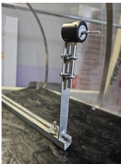
Slika 4.3 Stup vjetroagregata na čeličnoj vodilici
