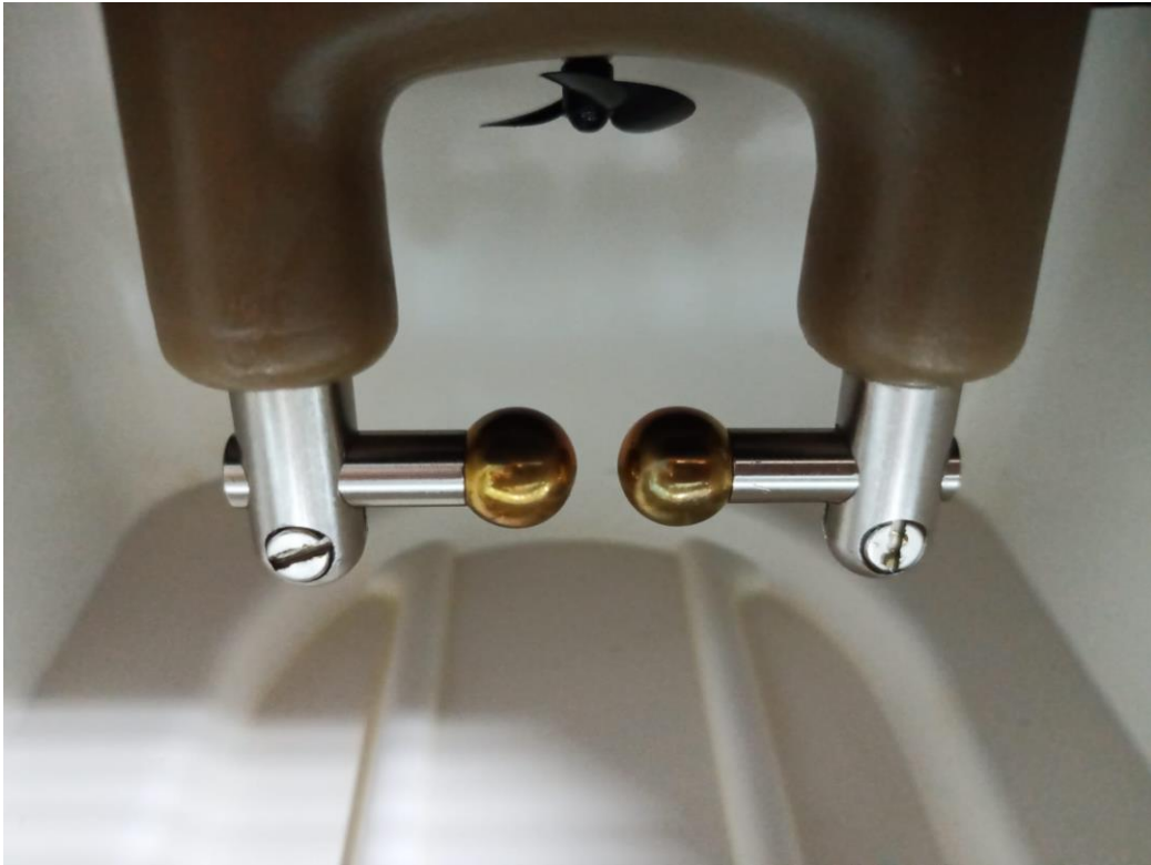
Slika 6.2. Prikaz elektroda mjernog instrumenta Megger OTS60PB na razmaku od 2,5 mm
