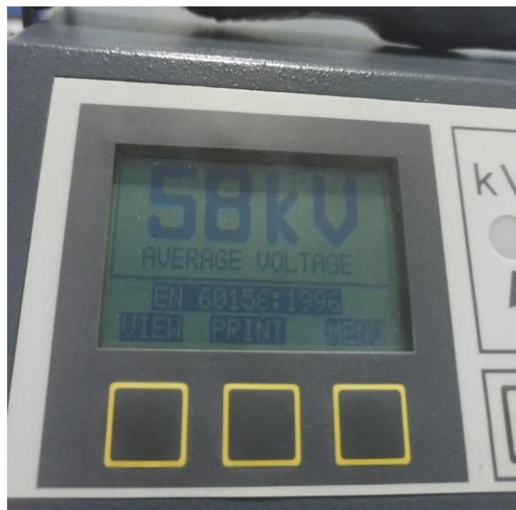
Slika 6.5. Prikaz izračuna srednje vrijednosti napona proboja pomoću mjernog uređaja
