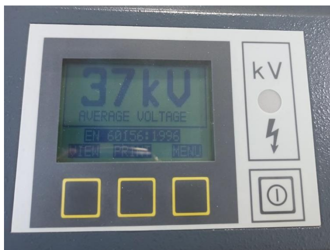
Slika 6.7. Prikaz izračuna srednje vrijednosti napona proboja pomoću mjernog uređaja
