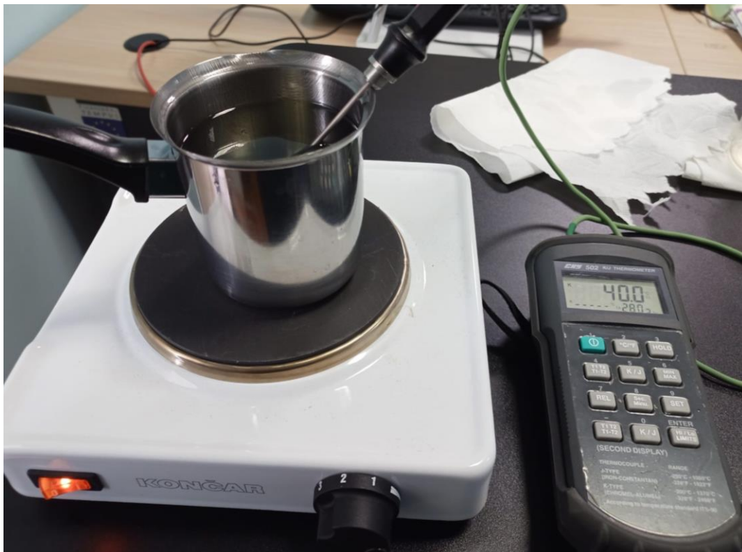
Slika 6.9. Postupak zagrijavanja ispitnog uzorka na željenu temperaturu
