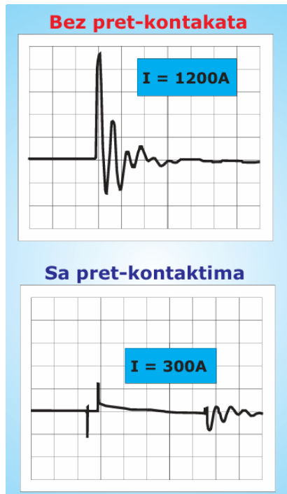
Slika 3.8 Dijagram uklopne struje kondenzatora sa i bez pret-kontakata [8].
