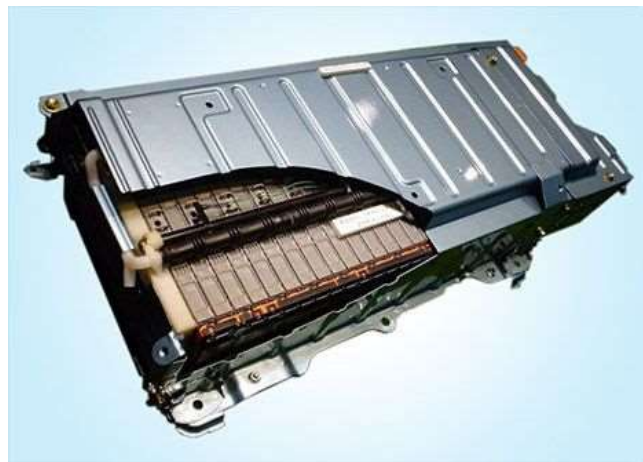
Slika 5.3. Nikal-metal hidridna baterija za električna vozila [46]
