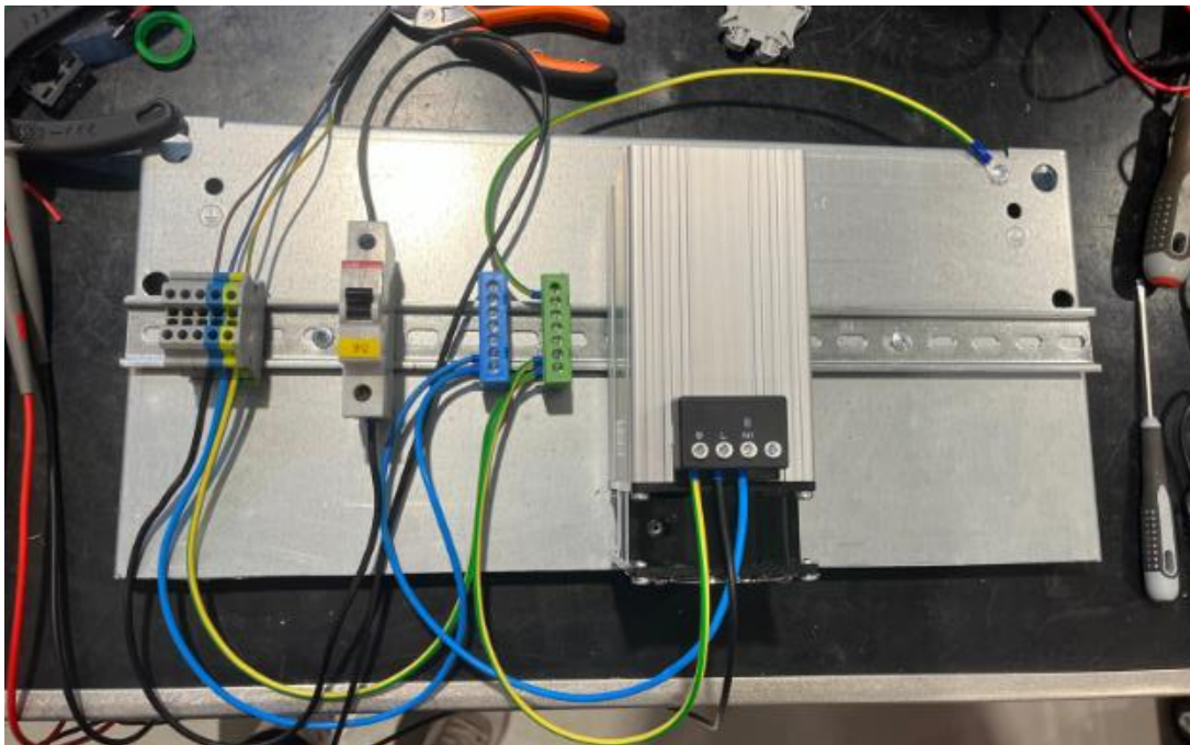
Slika 5.3.1. Maketa korištena za dobivanje rezultata mjerenja izmjenične (AC) struje
