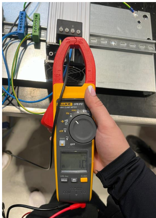
Slika 5.3.5. Mjerenje AC struje s FLUKE 376 FC strujnim klještima
