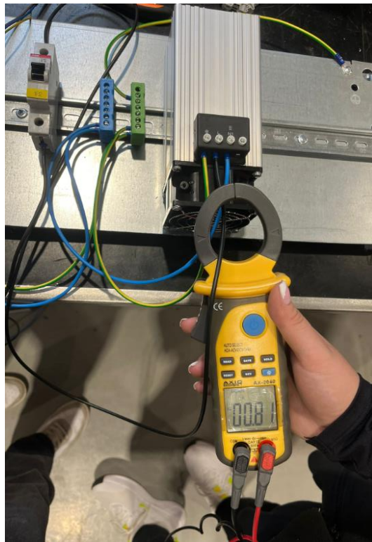
Slika 5.3.6. Mjerenje AC struje s AXIO MET AX-2040 strujnim klještima
