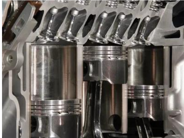
Slika 3.1. Prikaz klipa unutar cilindra [21].
