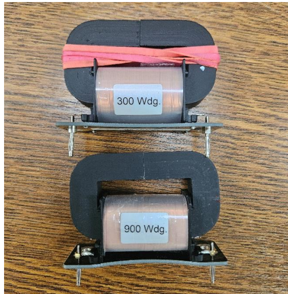
Slika 5.1. prigušnice korištene u pokusima
