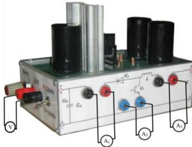
Sl. 1.12. Shema spajanja istosmjernog uzlaznog pretvarača.
