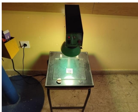
Slika 5.2. Osvjetljivanje pločice UV lampom
