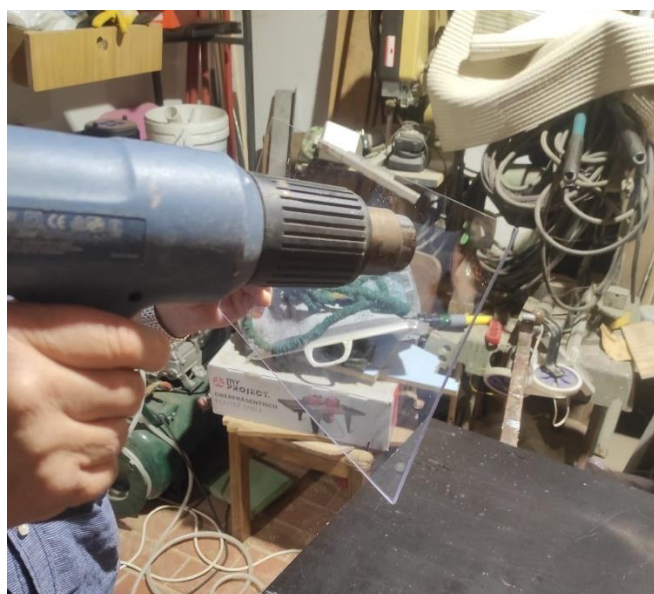
Slika 5.8. Zagrijavanje postolja prije savijanja
