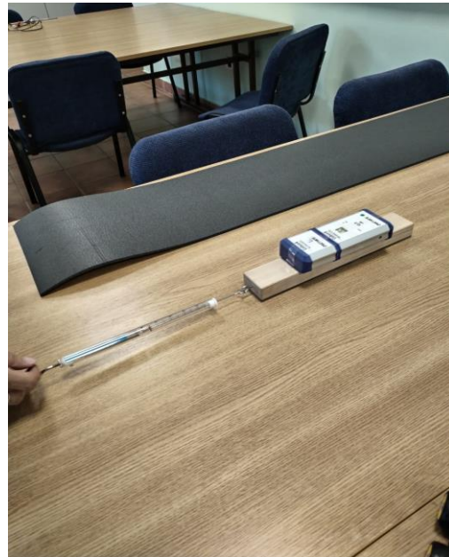
Slika 4.9. Postav eksperimenta dinamičko trenje
