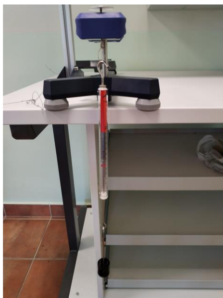
Slika 4.16. Postav eksperimenta određivanje frekvencije titranja opruge u ovisnosti o masi utega i konstanti opruge
