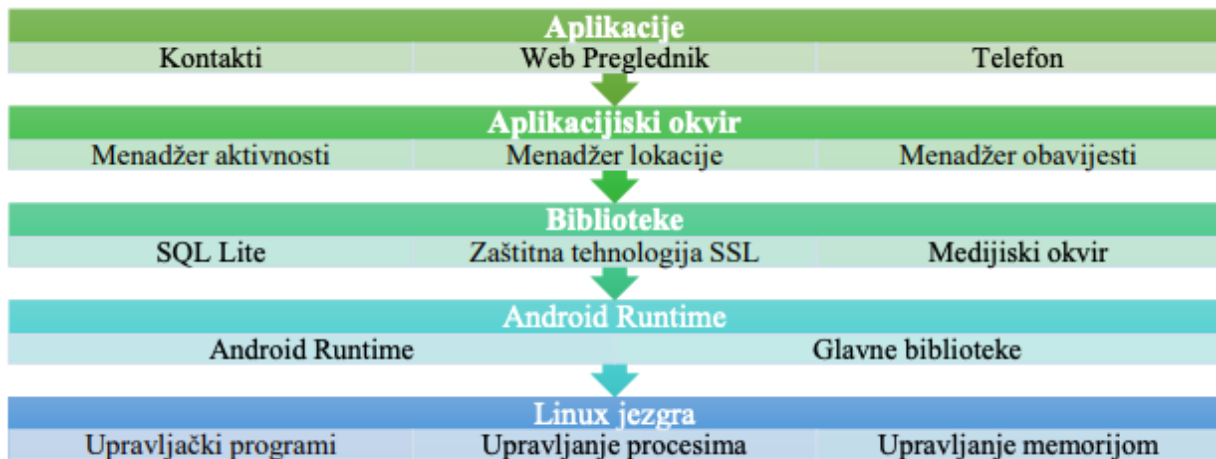
Slika 2.2. Arhitektura Android sustava.
