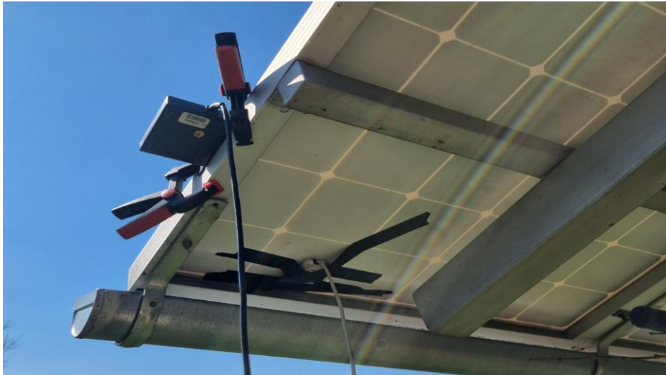
Sl. 4.3. Prikaz postavljanja senzora jakosti sunčevog zračenja i senzora temperature modula
