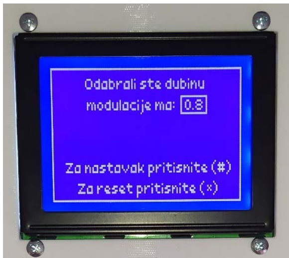
Slika 4.14. Potvrda odabira dubine modulacije tokom rada sklopa
