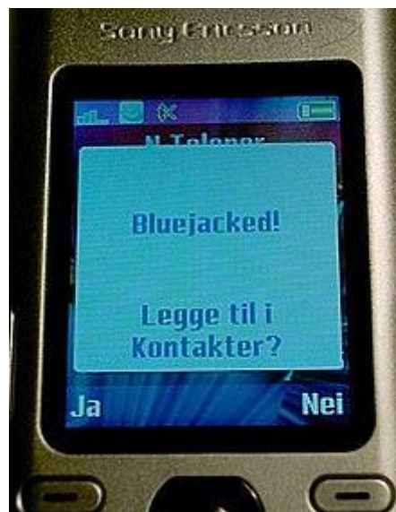
Slika 2.4. Primjer uspješnog Bluejacking napada. [6]
