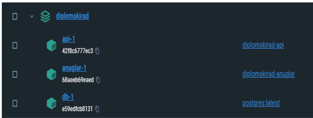
Slika 4.53 Docker mreža nastala nakon pokretanja docker-compose.yaml datoteke
