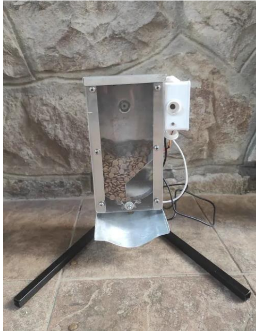
Slika 3.9. Konačna verzija konstrukcijskog rješenja hranilice.
