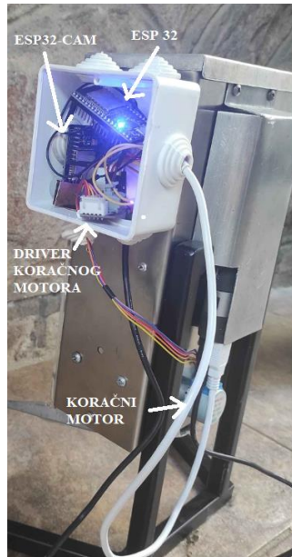
Slika 3.8. Komponente ugrađene na hranilicu.
