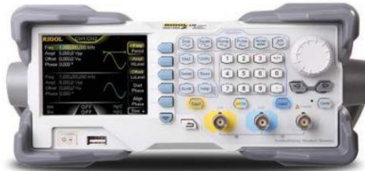
Slika 2.6. Rigol DG1032Z funkcijski generator.
