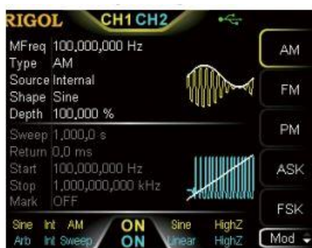
Slika 2.7. Prikaz ugrađenih modulacijskih postupaka funkcijskog generatora.
