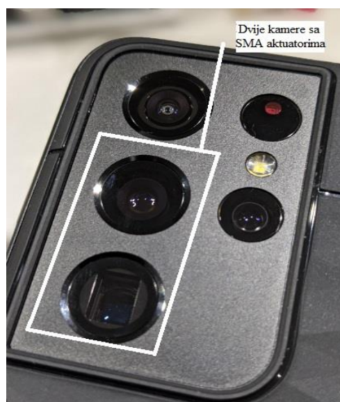
Sl. 4.8 Modul kamera Samsung Galaxy S21 ultra sa SMA stabilizatorom [26]
