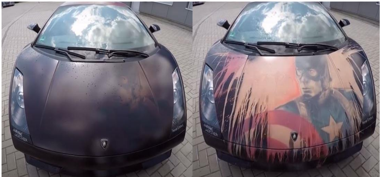
SI 2.16 Primjer premaz leuko boje na automobilu pri promjeni temperature [16]
