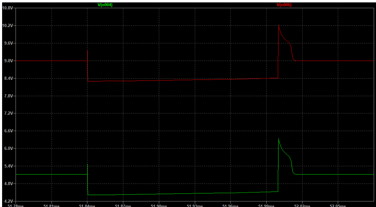
Sl. 5-9 Simulacijski prikaz tranzijenta nakon filtracije istosmjerne komponente
