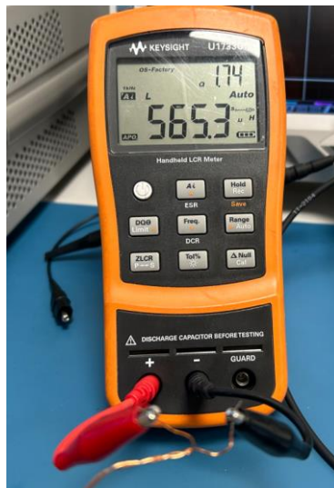
Sl. 5-1 Mjerenje induktiviteta PI zavojnice RLC-metrom
