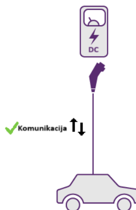
Slika 4.11. Način 4 - punjenje pomoću javne punionice, istosmjerna struja [38]
