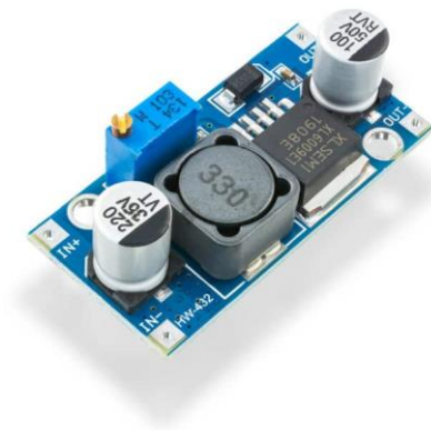
Slika 3.4. Prikaz XL6009 step-up modula
