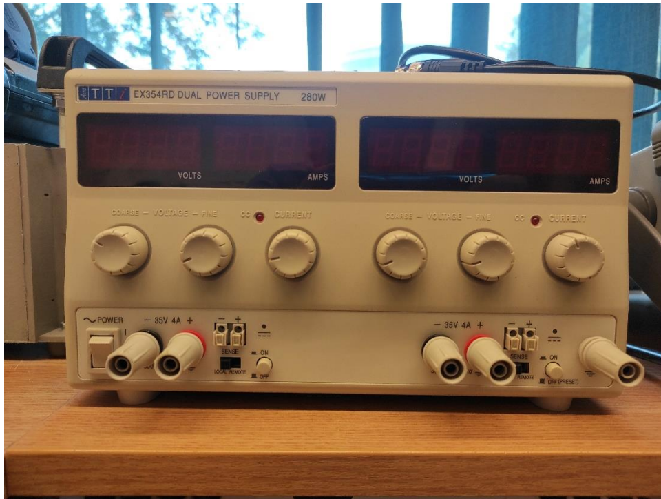
Slika 3.14. Laboratorijsko napajanje EX354RD.
