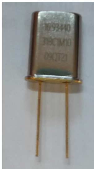
Slika 3.12. QT kvarcni oscilator za rad na trećem harmoniku.
