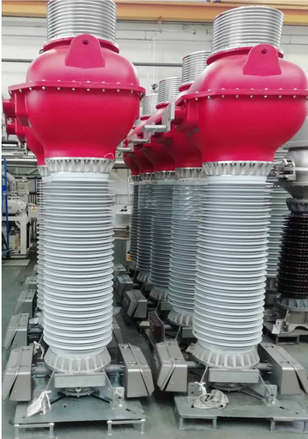
Slika 2.22.: Kombinirani mjerni transformator tvornice Končar
