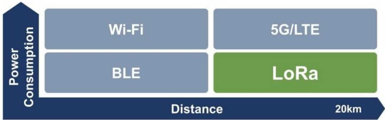
Slika 3.1. Usporedba potrošnje energije sa dometom komunikacije kod 4 različita sustava komunikacije[6].
