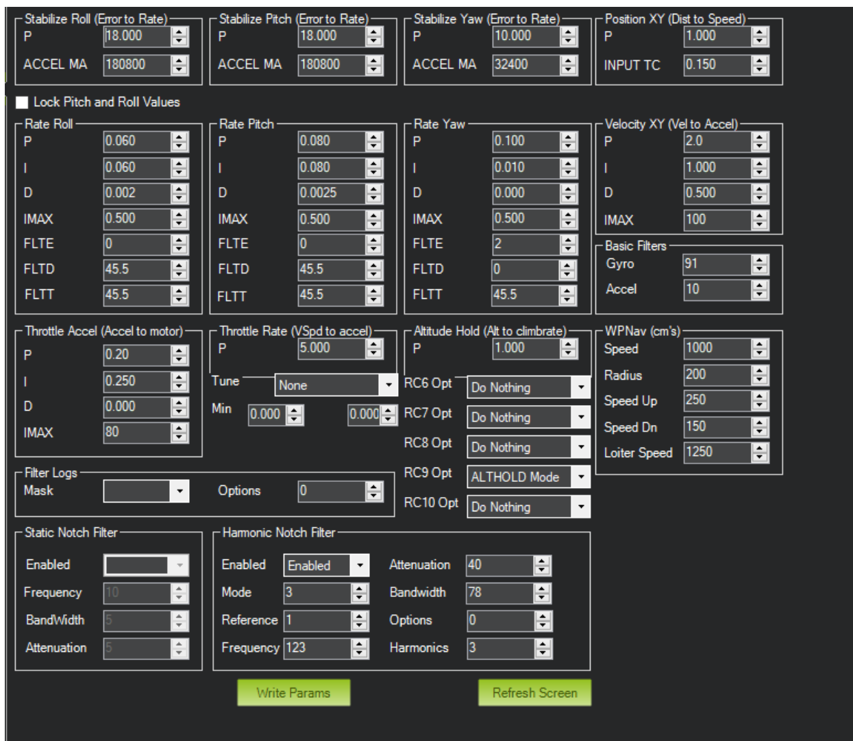
Slika 5.7. Poblži prikaz svih vrijednosti PID parametara
