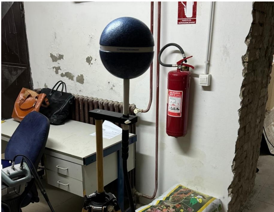
Slika 4.3 Prijemna izotropna antena R&S TS-EMF sustava
