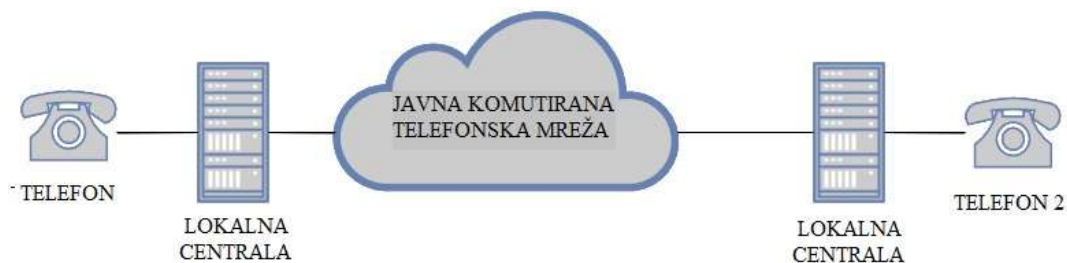
Slika 3.1. Struktura fiksne analogne govorne telefonske usluge
