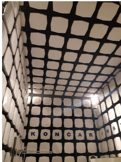
Slika 6.1. Prikaz RF apsorbera unutar komore
