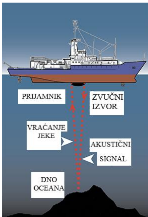
Slika 5.1. Ehosonda izračunava dubinu vode [7]
