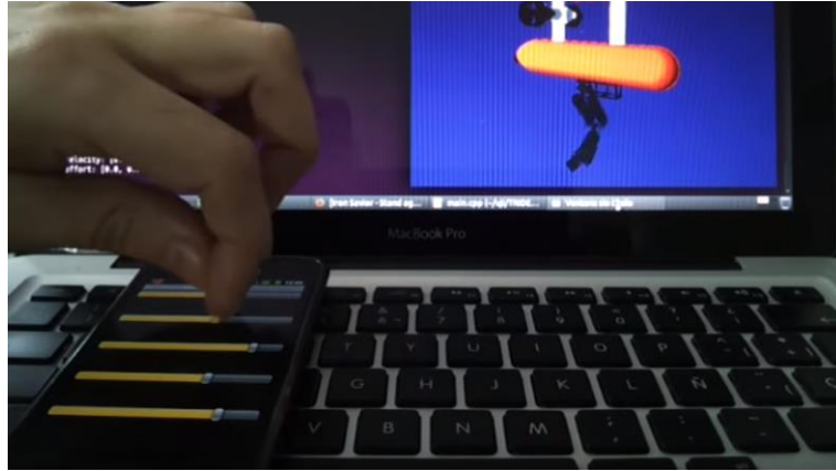
Slika 2.10 Upravljanje robota putem Android OS-a
