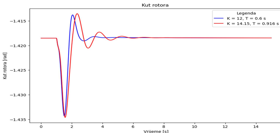
Slika 4.184 Usporedba kuta rotora za stabilizator parametriman analitičkom metodom i metodom roja čestica, scenarij 6
