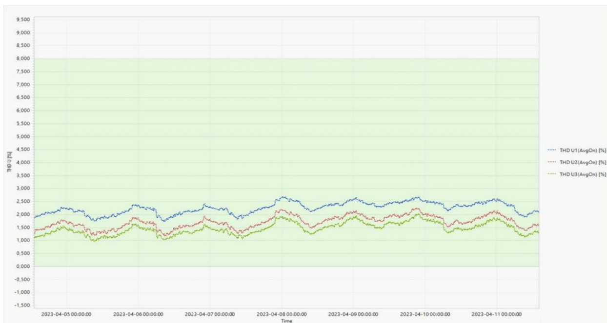
Slika 5.12. Ukupno harmonijsko izobličenje napona THDU u mjernom tjednu [14].
