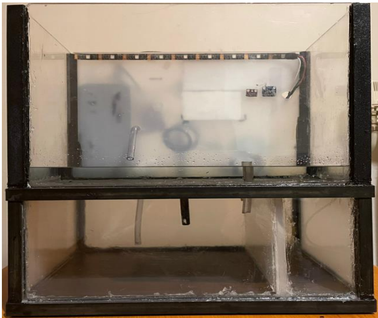
Slika 4.3. Test vodonepropusnosti gornjeg dijela konstrukcije
