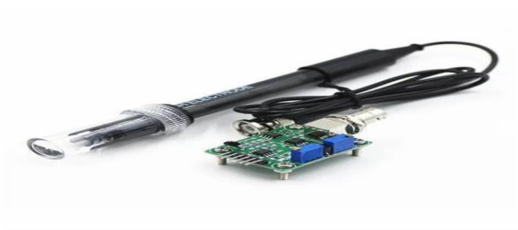
Slika 3.6. Senzor za očitavanje pH vrijednosti [10]
