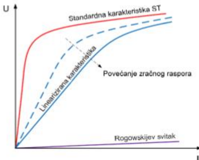
Slika 2.5. Naponsko-strujne karakteristike strujnog transformatora i Rogovskijevog svitka.[3]
