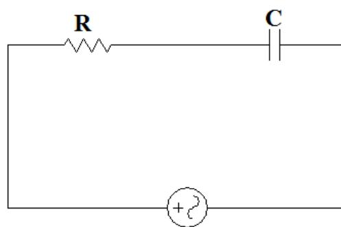
**Sl. 2.4.** Serijski spoj otpornika i kondenzatora.
