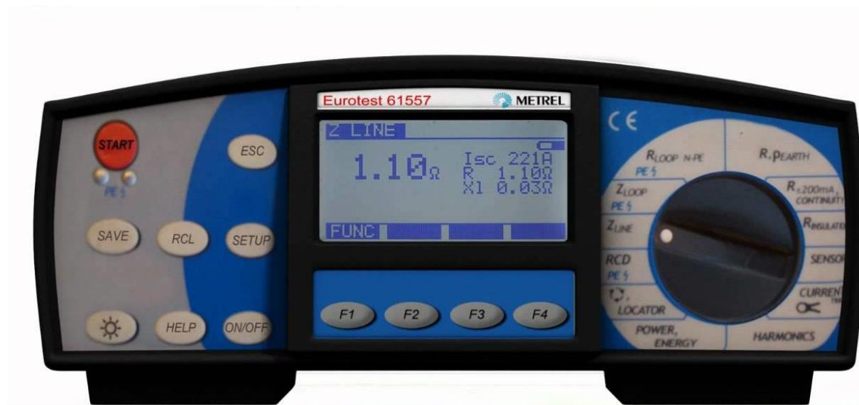
**Sl. 5.2. Prikaz preklopke Metrela na položaj  $Z_{LINE}$  prilikom izvođenja mjerenja impedancije kratkospojne petlje.**
