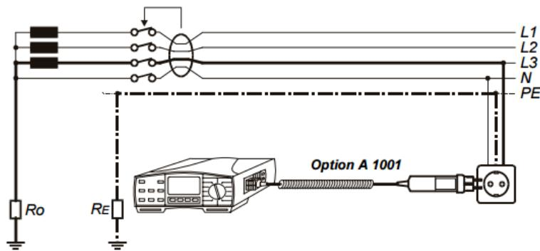
**Sl. 5.3.** Shema spajanja mjernog uređaja na kućnu instalaciju [13].
