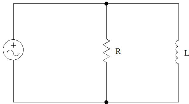
**Sl. 2.5.** Paralelni spoj otpornika i zavojnice.
