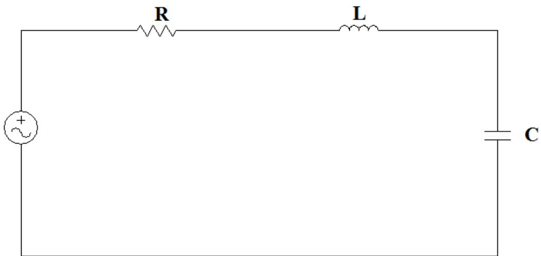
**Sl. 2.2.** Izmjenični strujni krug koji sadržava otpornik, zavojnicu, kondenzator i izmjenični izvor napajanja.
