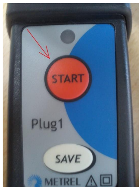
Sl. 5.9. Pokretanje mjerenja na plug commanderu.
