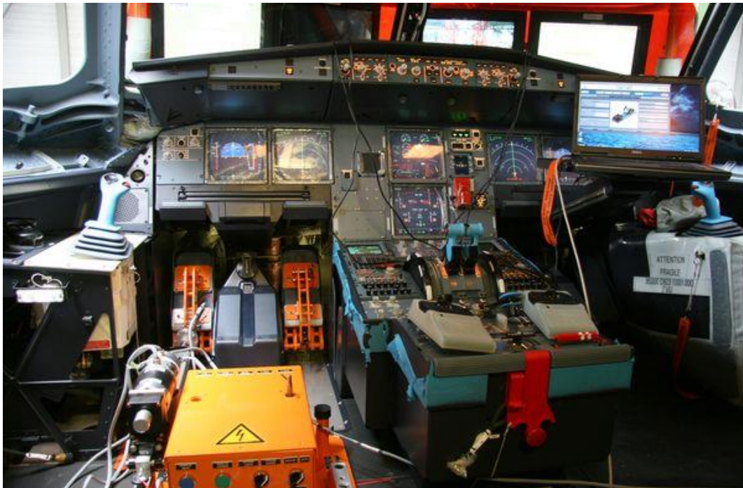
Slika 6.4. Mjerenje sile pritiska na papučice u zrakoplovu
