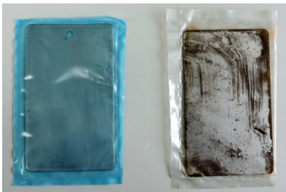
Slika 3.5.1.1. Primjer zaštićenog i nezaštićenog uzorka, [28].
