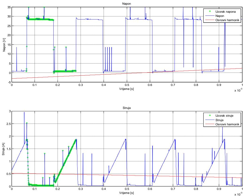
**Slika 3.33.** Valni oblici napona i struje u MATLAB-u za odabranu mjerenu (Sl. 3.31.).
