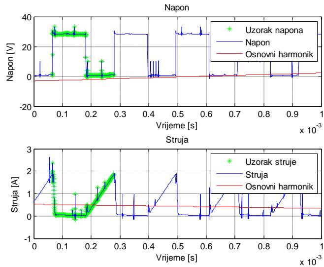
**Slika 3.38.** Valni oblici napona i struje nakon filtriranja (0,75).
