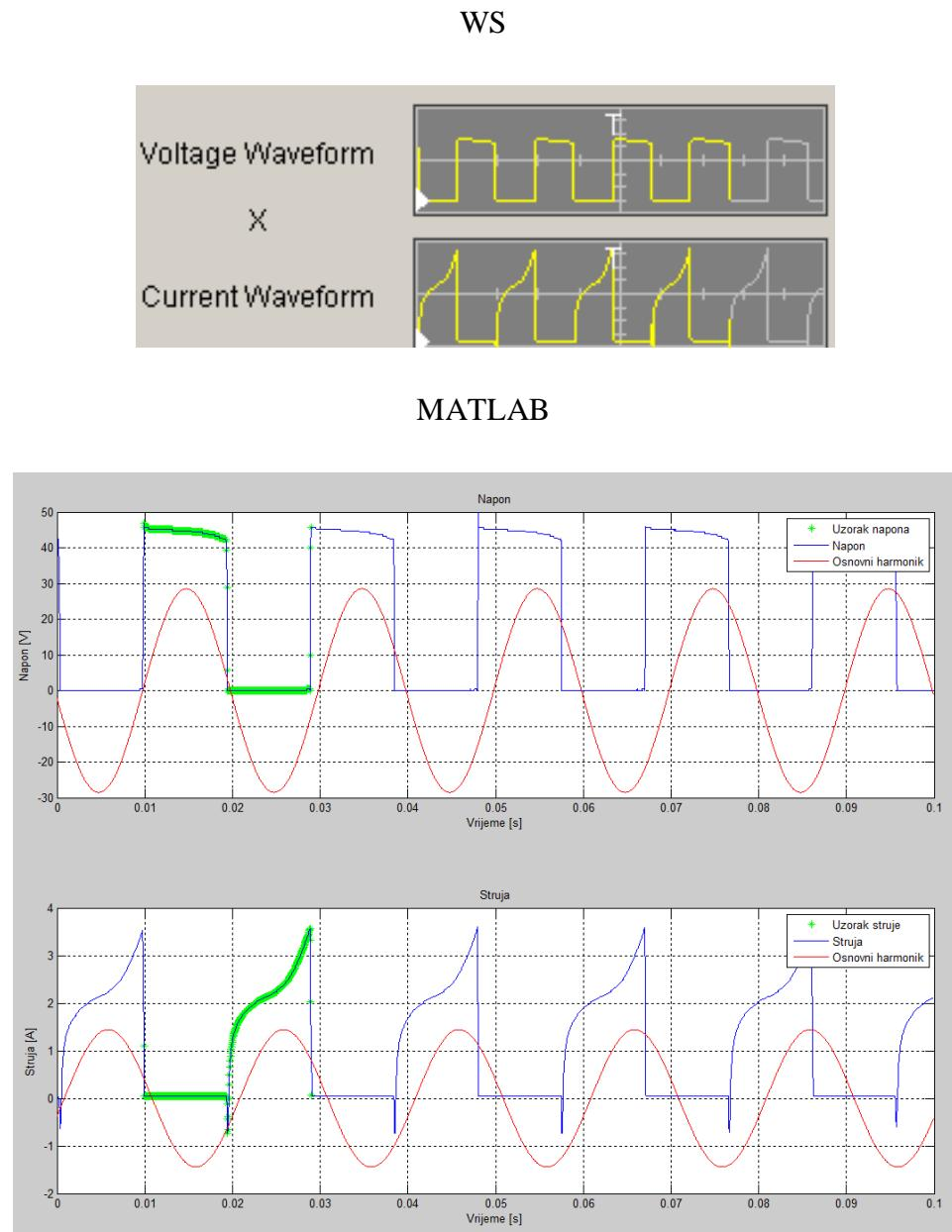
**Slika. 3.15.** Usporedba valnih oblika napona i struje u WS-u i MATLAB-u.
