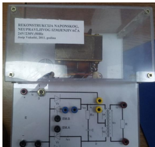
Slika 3.12. Korištena maketa naponskog, neupravljivog izmjenjivača u mjerjenju.
