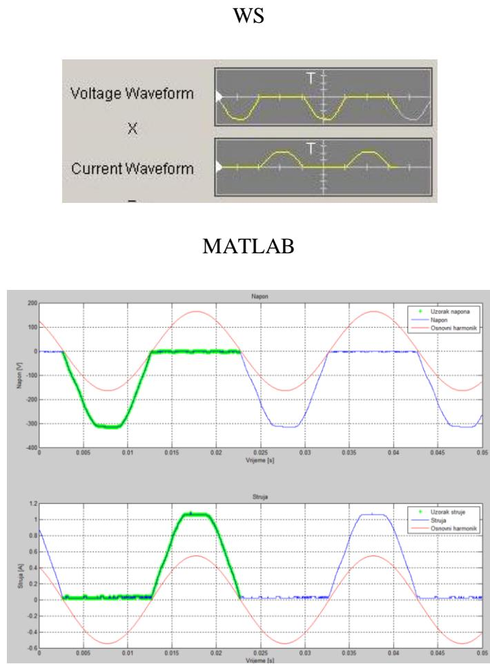
**Slika. 3.3.** Usporedba valnih oblika napona i struje u WS-u i MATLAB-u.
