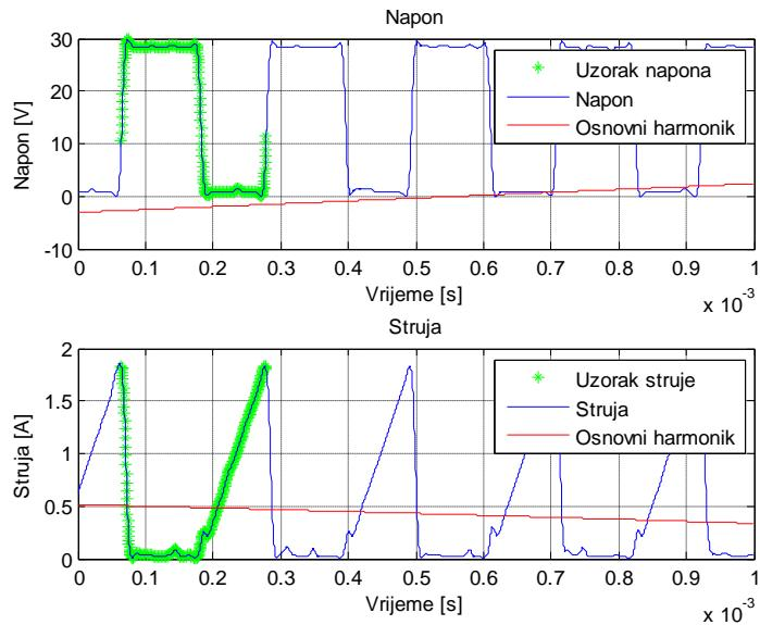
**Slika 3.37.** Valni oblici napona i struje nakon filtriranja (0,05).
