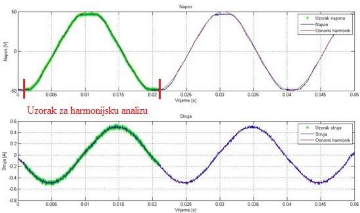
**Slika 2.7.** Usporedba amplituda napona i struje u MATLAB-u.
