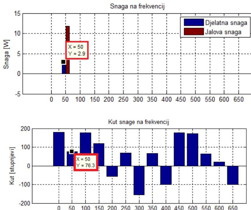
**Slika. 2.15.** Proračun snage u MATLAB-u s uzorcima 50 i 1050, kut snage na osnovnom harmoniku ( $\rho=76,3^\circ$ ).
