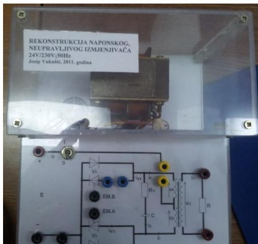
**Slika 3.12.** Korištena maketa naponskog, neupravljivog izmjenjivača u mjerenuju.
