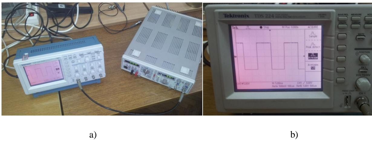
**Slika 2.1.** a) povlačenje signala s generatora funkcija na osciloskop,
