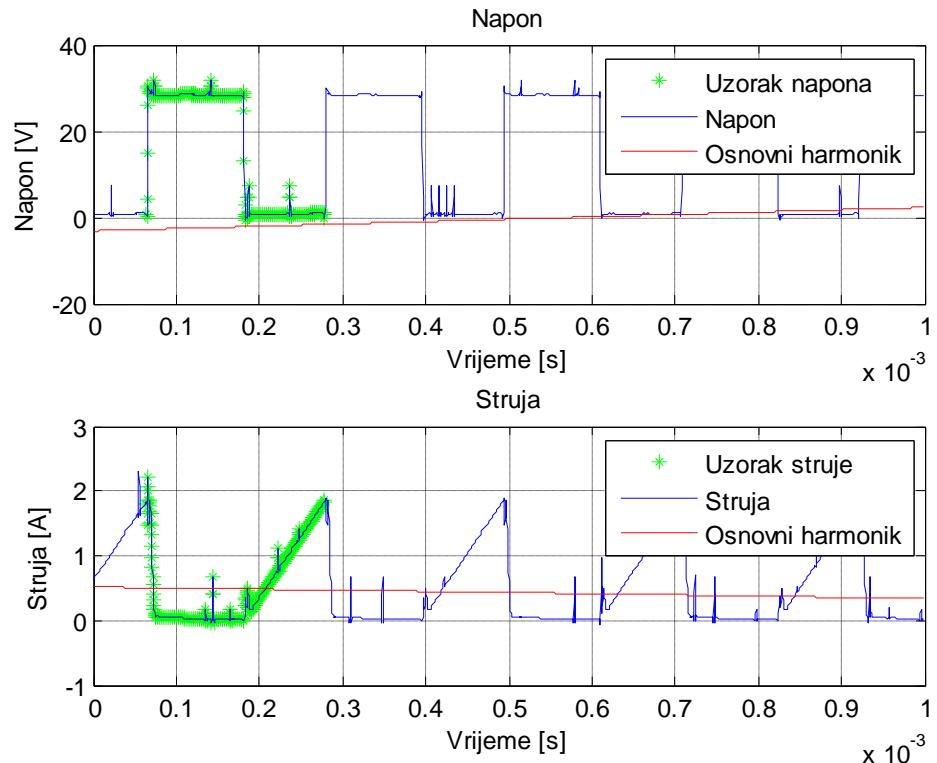
**Slika 3.36.** Valni oblici napona i struje nakon filtriranja (0,5).
