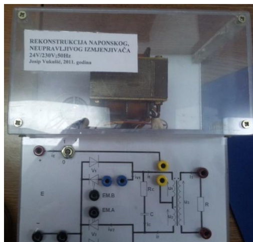
Slika 3.12. Korištena maketa naponskog, neupravljivog izmjenjivača u mjeranju.
