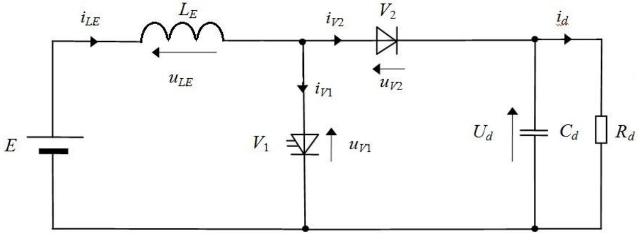
**Slika 3.27.** Nadomjesna shema spoja uzlaznog pretvarača napona
