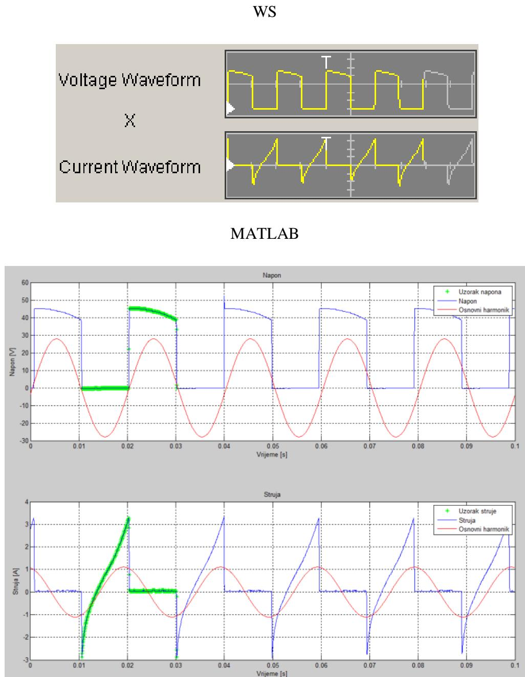
**Slika. 3.24.** Usporedba valnih oblika napona i struje u WS-u i MATLAB-u
