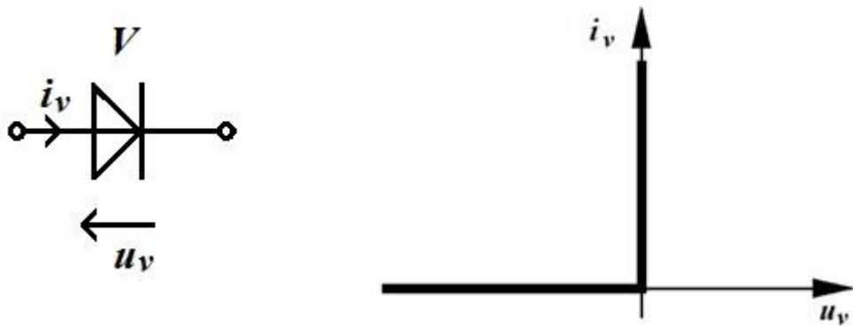
**Slika 3.2.** Simbol i karakteristika neupravljive sklopke (idealne diode)[2].
