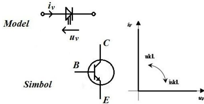
**Slika 3.29.** Model, simbol i karakteristika bipolarnog tranzistora.
