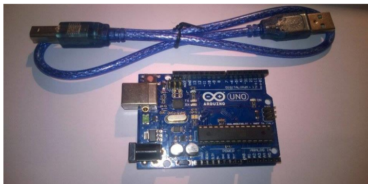
Slika 3.1. - Arduino UNO sa mikrokontrolerom ATMEGA328P i USB kablom
