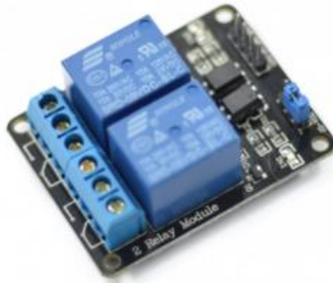
Slika 3.5. - Modul s relejom- dvokanalni
