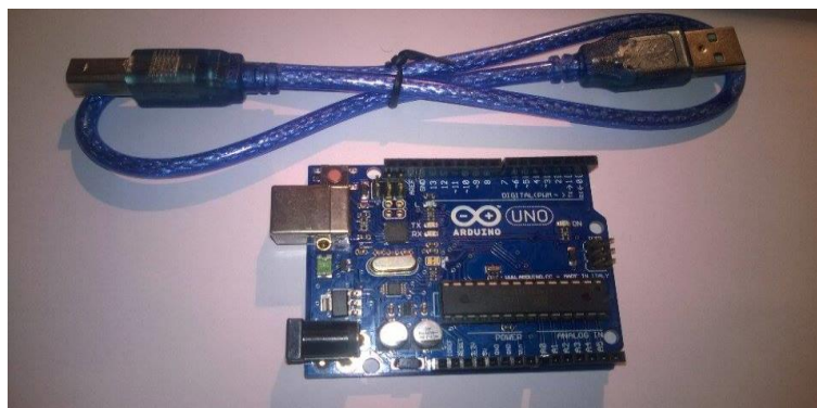
Slika 3.1. - Arduino UNO sa mikrokontrolerom ATMEGA328P i USB kabal
