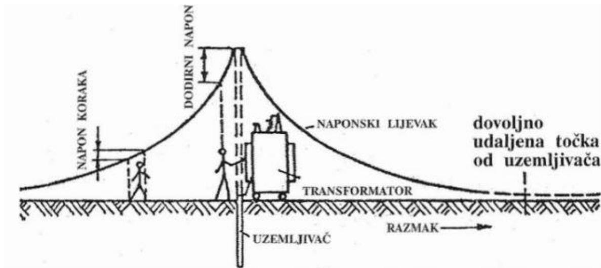
Slika 2.1) Razdioba potencija oko uzemljivača [2]
