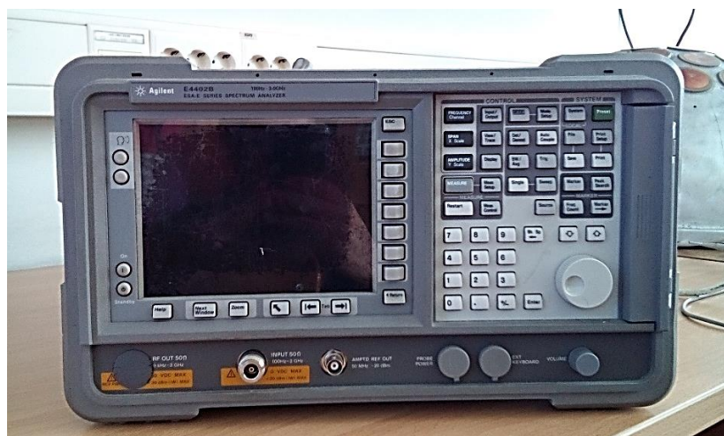
Slika 3.7. Spektralni analizator Agilent ESA-E E4402B
