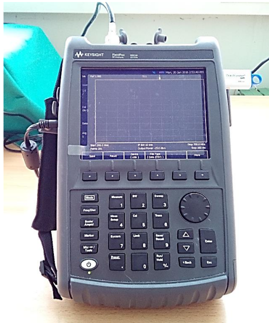
Slika 3.5. Spektralni analizator AGILENT FieldFox N9912A
