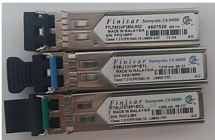
Slika 4.25 Prikaz korištenih SFP modula (I, II i III prozor)
