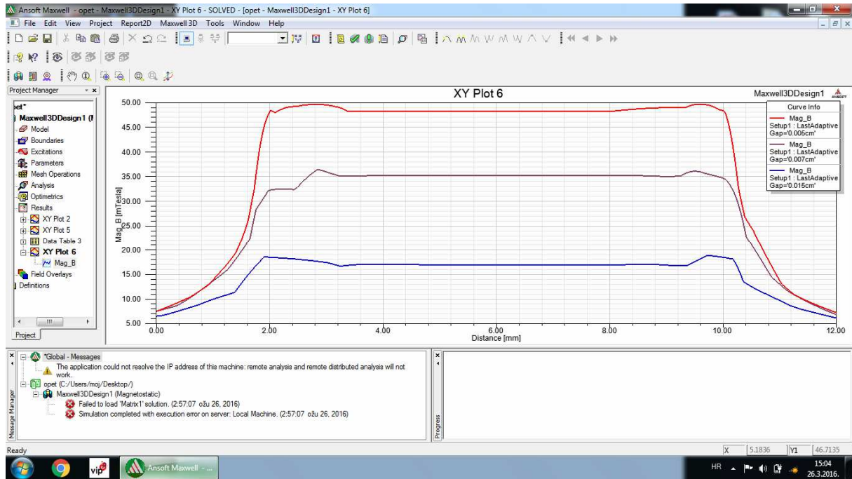
Slika 11.9. Indukcija u različitim zračnim rasporema
