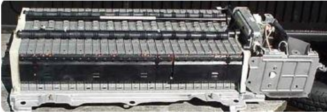
Slika 2.12. Nikal-metal hidridne (NiMH) baterije
