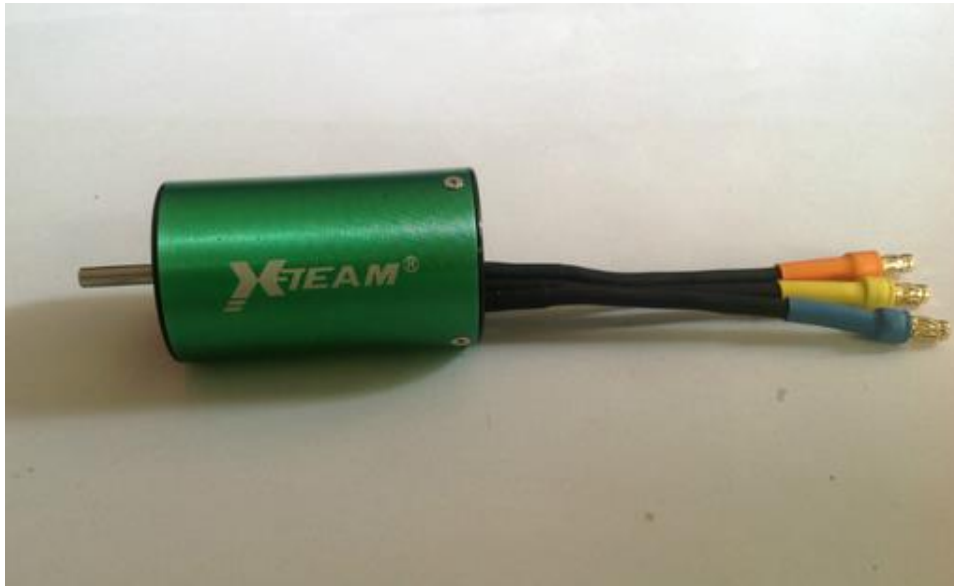
Slika 3.3. Izgled inrunner DC motor bez četkica [4]
