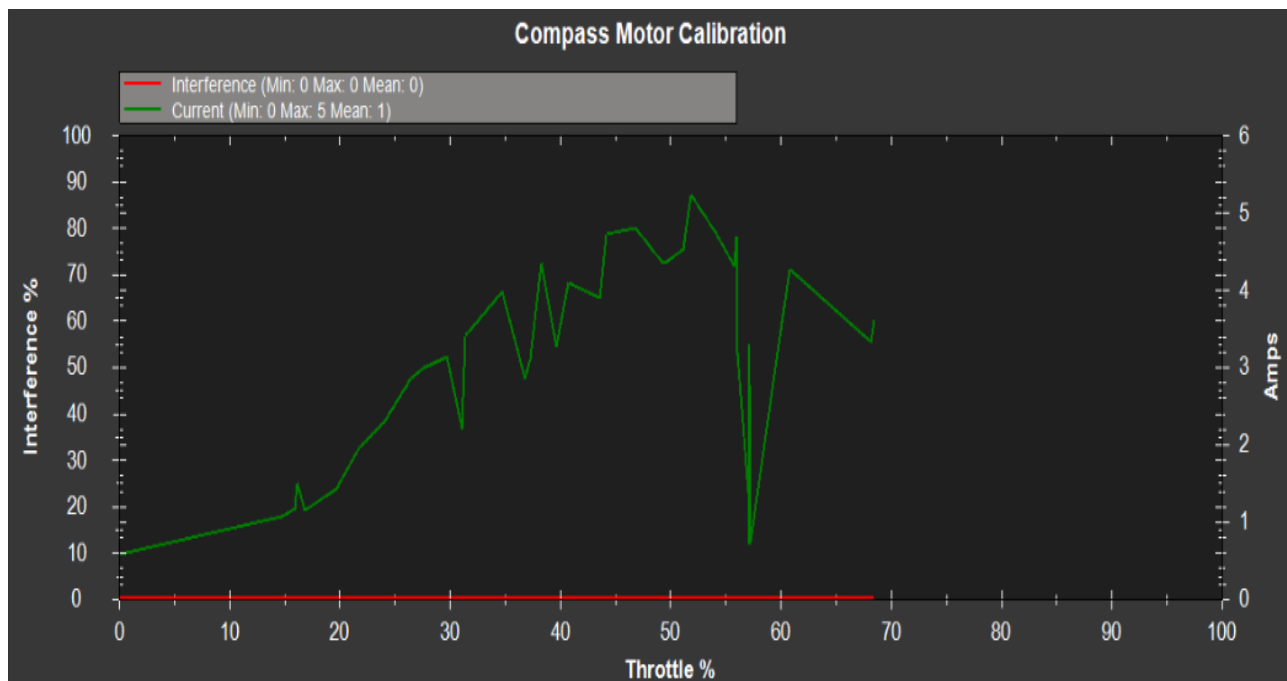
Slika 3.10. Potezna struja prilikom laganog podizanja letjelice
