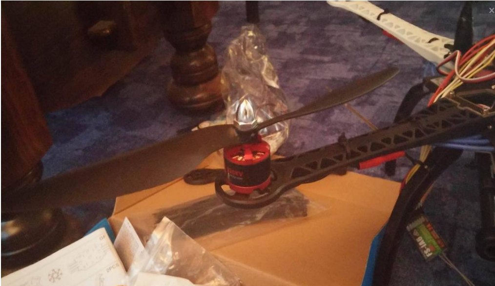
Slika 3.6. Outrunner DC motor sa propelerom
