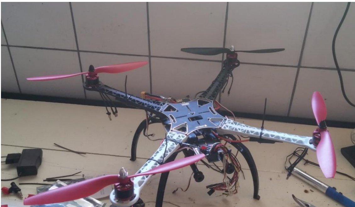
Slika 10.2. Montiranje poklopca na središnjem dijelu letjelice
