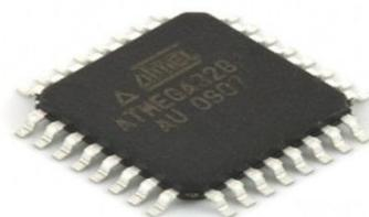
*Slika 2.2. Prikaz Atmega328P mikrokontrolera*
