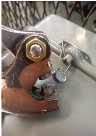
Sl. 4.1. Kliješta za utiskivanje ovjernog žiga na plombu ispitanog brojila
