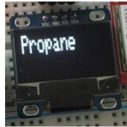
Sl. PD.11. Ispis zaslona pri odabiru tipa plina 6, odnosno očitavanje propana u zraku.
