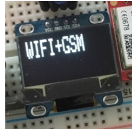
Sl. PD.2. Prikaz zaslona kada se odabere način rada 1, odnosno slanje informacija putem WiFi i GSM veze.
