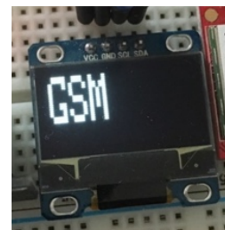
Sl. PD.4. Ispis zaslona kada se odabere način rada 3, odnosno slanje informacija isključivo putem GSM veze.
