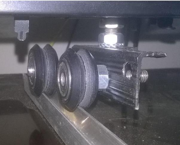
Sl. 3.5. – Konstrukcija s kotačićima na aluminijskom ležaju.
