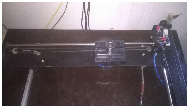
Sl. 3.2. – Pomična os s postoljem za magnet i magnetom.
