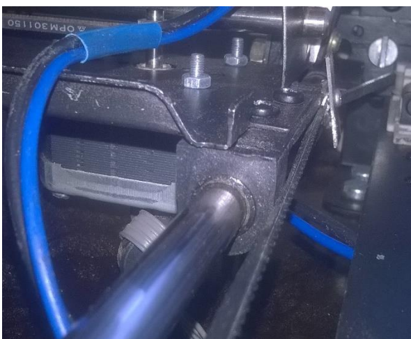
Sl. 3.4. – Linearni ležaj i osovina.
