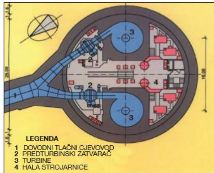
Slika 4.10. Pogled na halo strojarnice (od gore)
