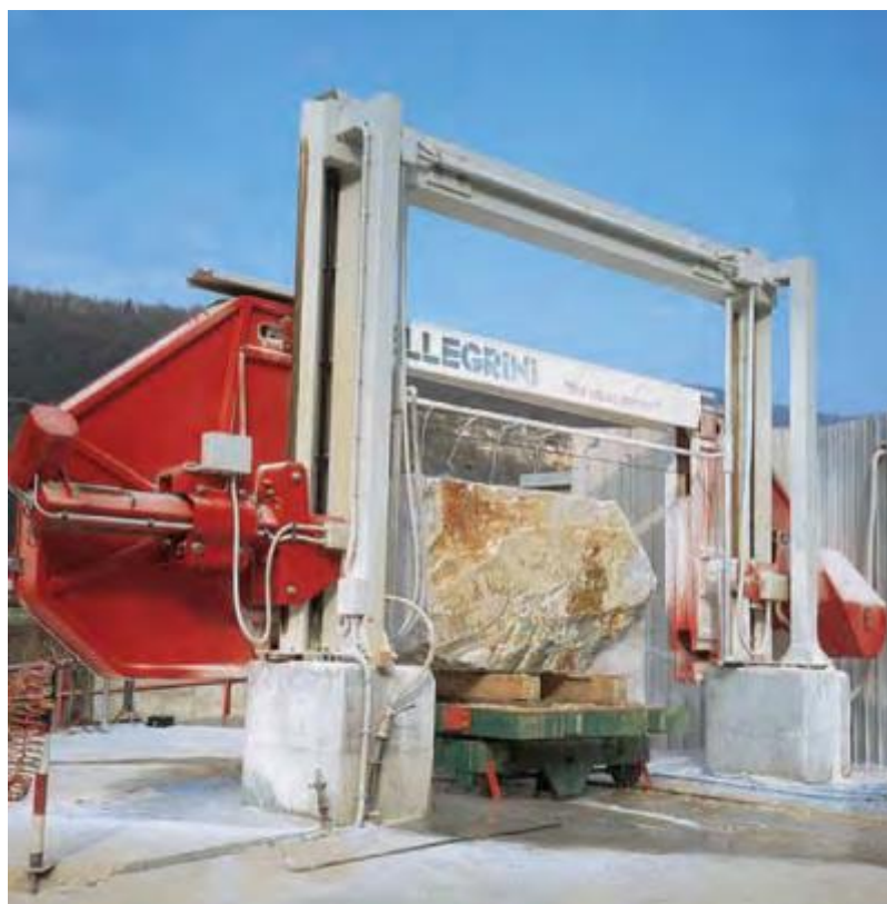
Slika 5.14. Filo sajla za rezanje kamena
