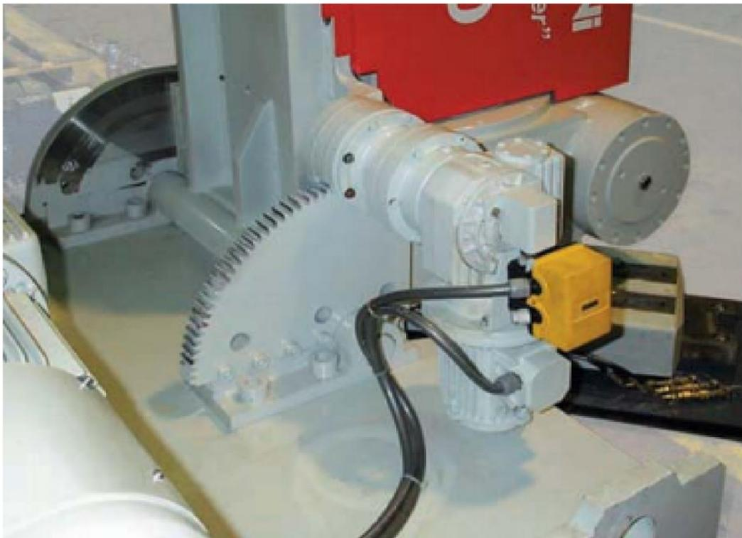
**Slika 5.8.** Motor za pozicioniranje pile
