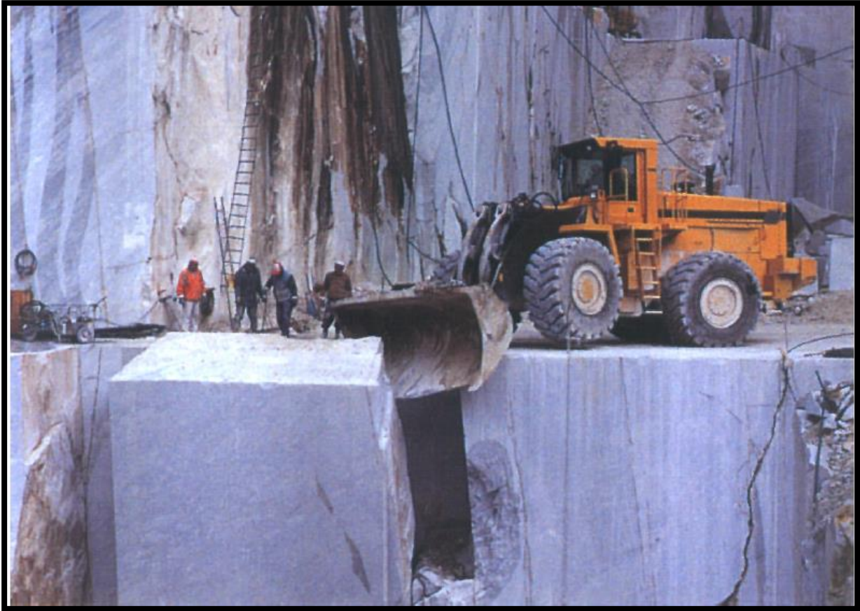
Slika 4.11. Rušenje primarnog bloka utovaračem
