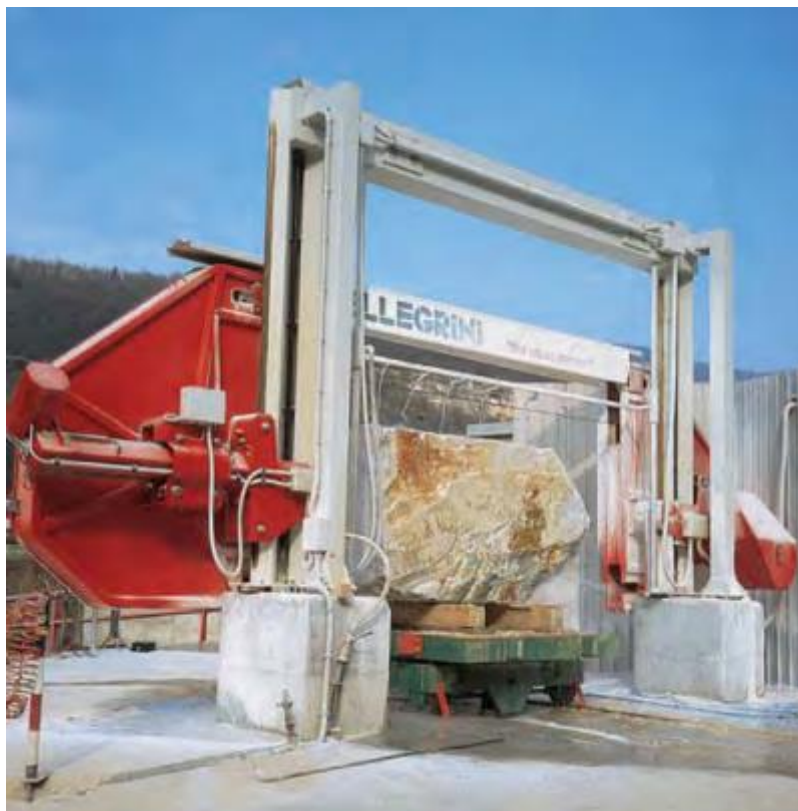
Slika 5.14. Filo sajla za rezanje kamena
