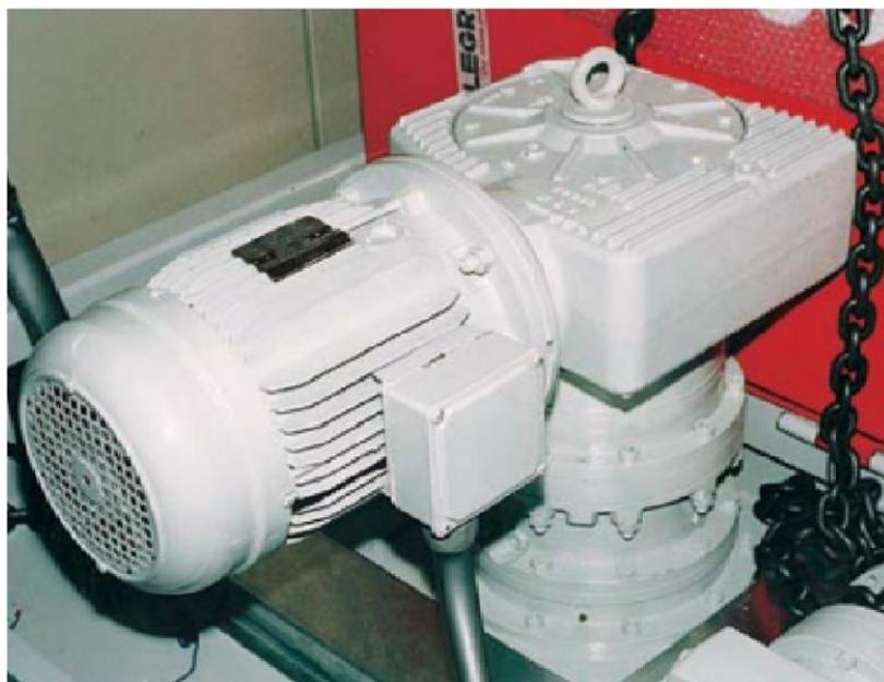
**Slika 5.6.** Motor za pomicanje sjekačice po tračnicama
