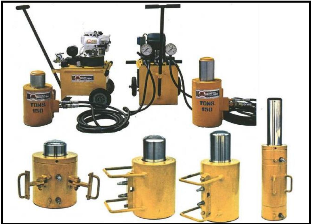
Slika 4.8. Hidraulični potiskivači
