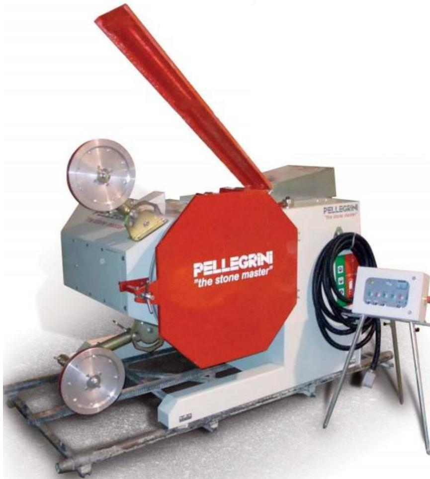
**Slika 5.10.** Dijamantna žična pila tvrtke Pellegrini
