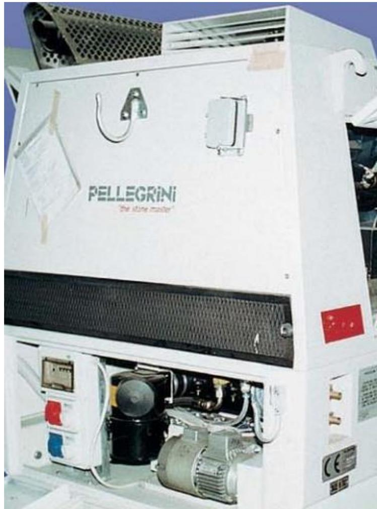
**Slika 5.11.** Sustav hlađenja i kućište
