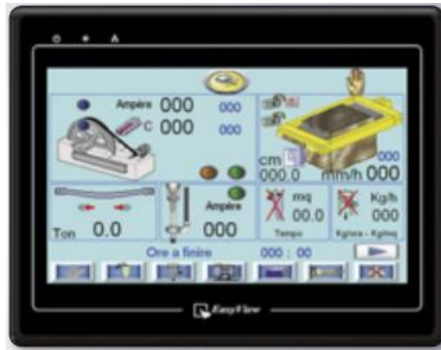
Slika 5.25. Ekran kojim upravljamo strojem
