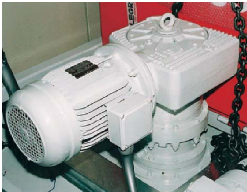
Slika 5.6. Motor za pomicanje sjekačice po tračnicama
