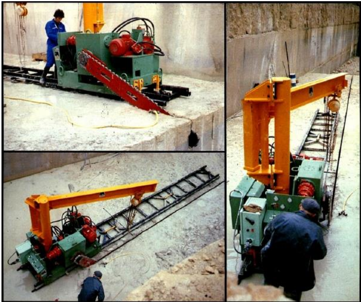
Slika 4.15. Lančana sjekačica u kamenolomu
