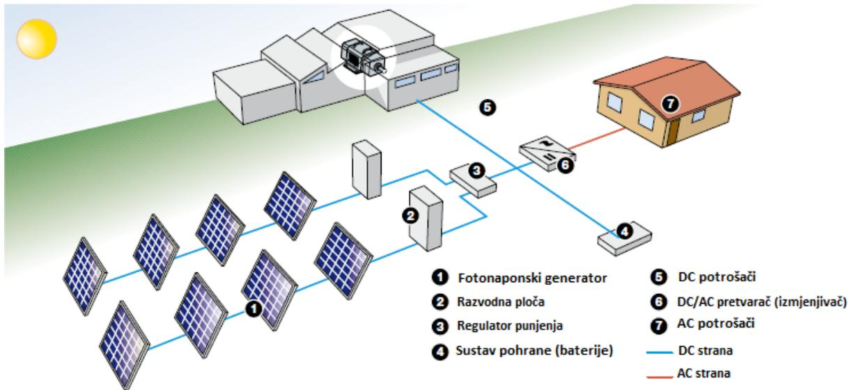
**Slika 2.11.** Samostalni fotonaponski sustav [1]
