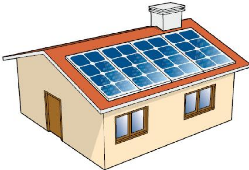
Slika 4.2. Fotonaponska instalacija bez gromobranske zaštite [1]
