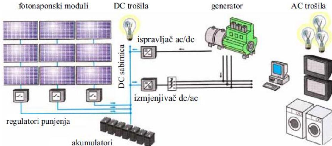
**Slika 2.12.** Shema samostalnog hibridnog fotonaponskog sustava s generatorom [9]
