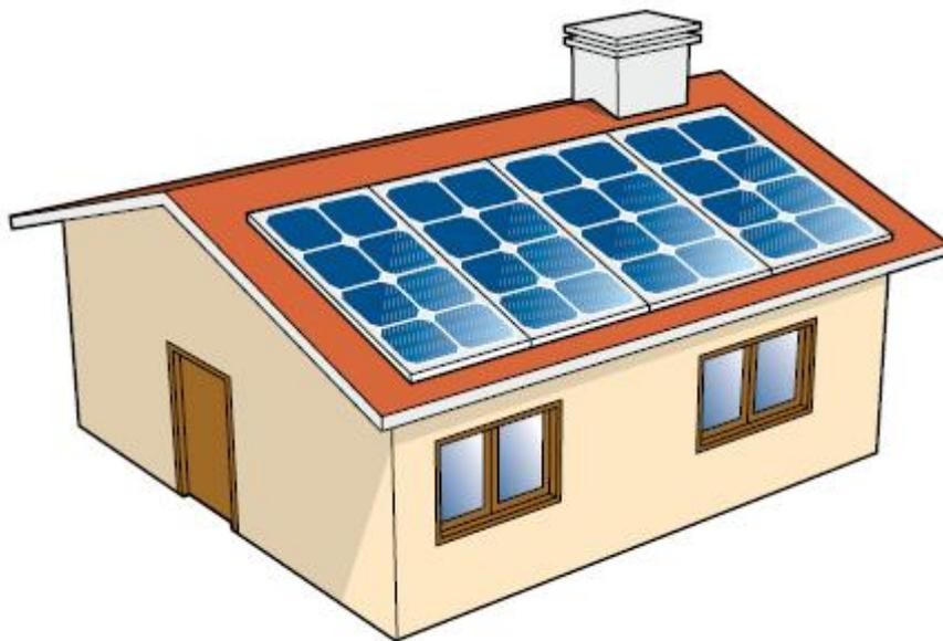
**Slika 4.2.** Fotonaponska instalacija bez gromobranske zaštite [1]
