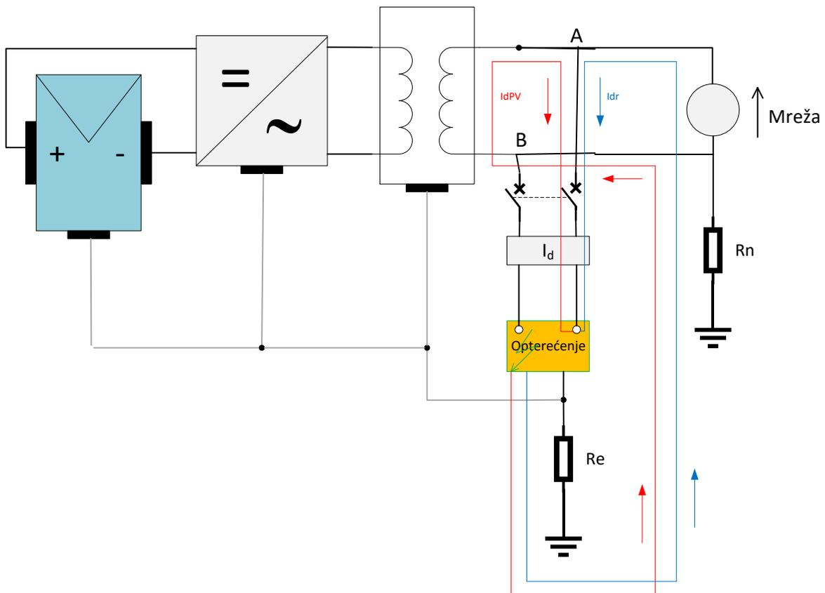
**Slika 3.3.** TT sustav zaštite izloženih vodljivih dijelova od utjecaja mreže i FN generatora
