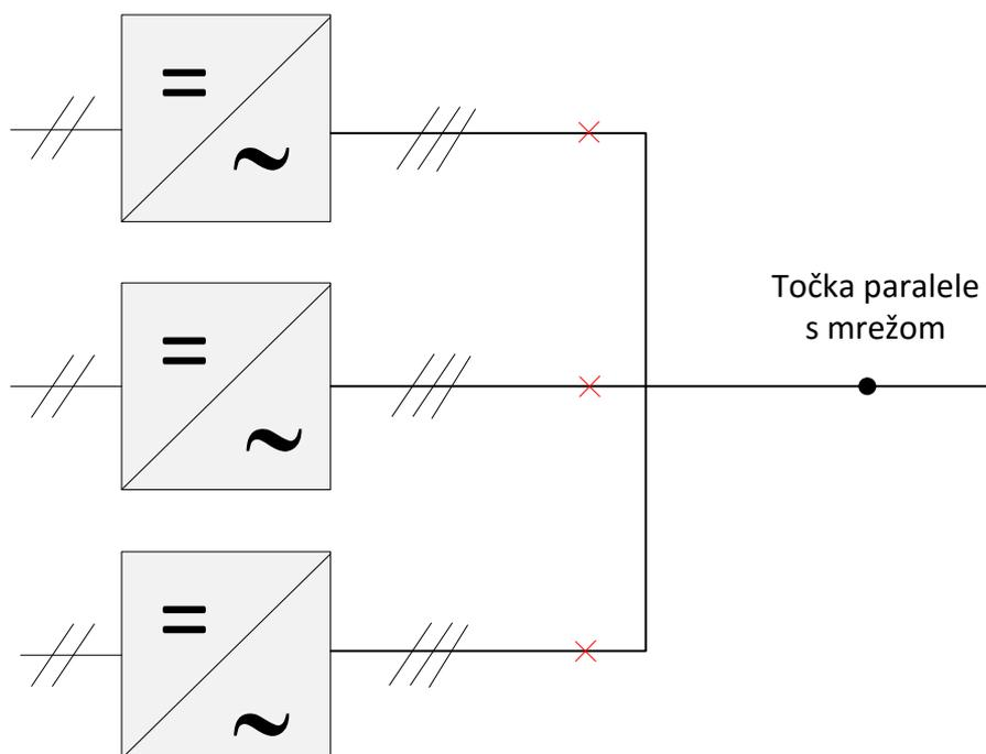
**Slika 4.1.** *Sustav zaštite postrojenja kod elektrana s višestrukim izmjenjivačima*
