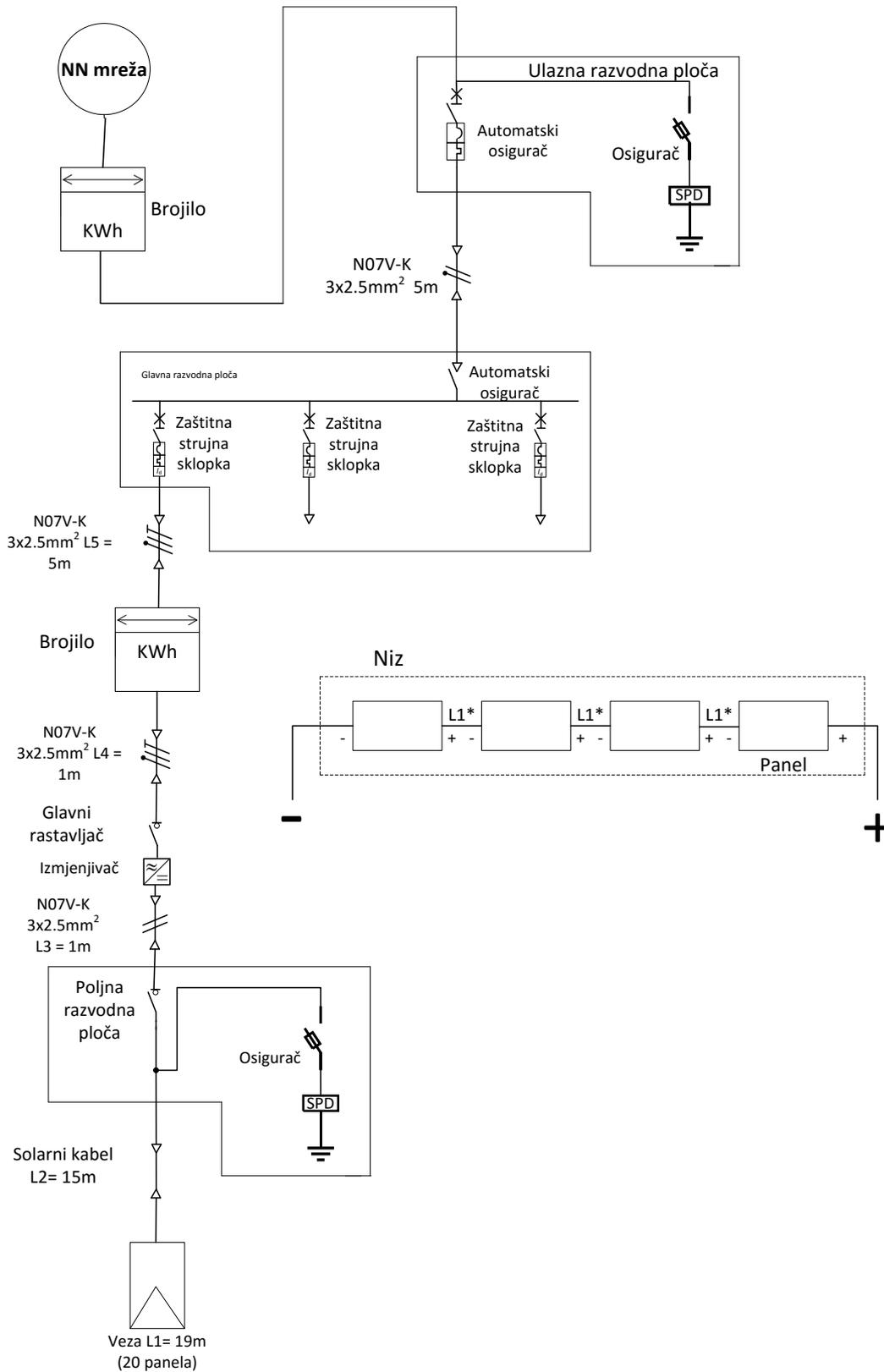
**Slika 5.1.** Fotonaponski sustav sa svim elementima zaštite
