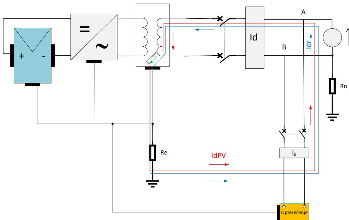
**Slika 3.4.** Strujna sklopka u TT sustavu
