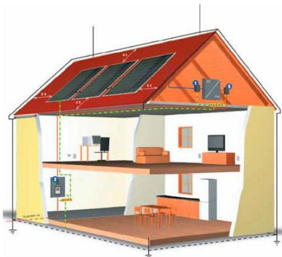
**Slika 4.6.** Fotonaponski sustav i gromobranska instalacija građevine [9]
